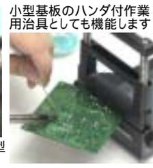
クランプ幅: 72mmと広いので、大型コネクタのハンダ付作業にも最適
